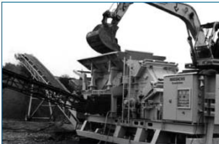
Maquinaria móvil para el reciclaje de escombros.
