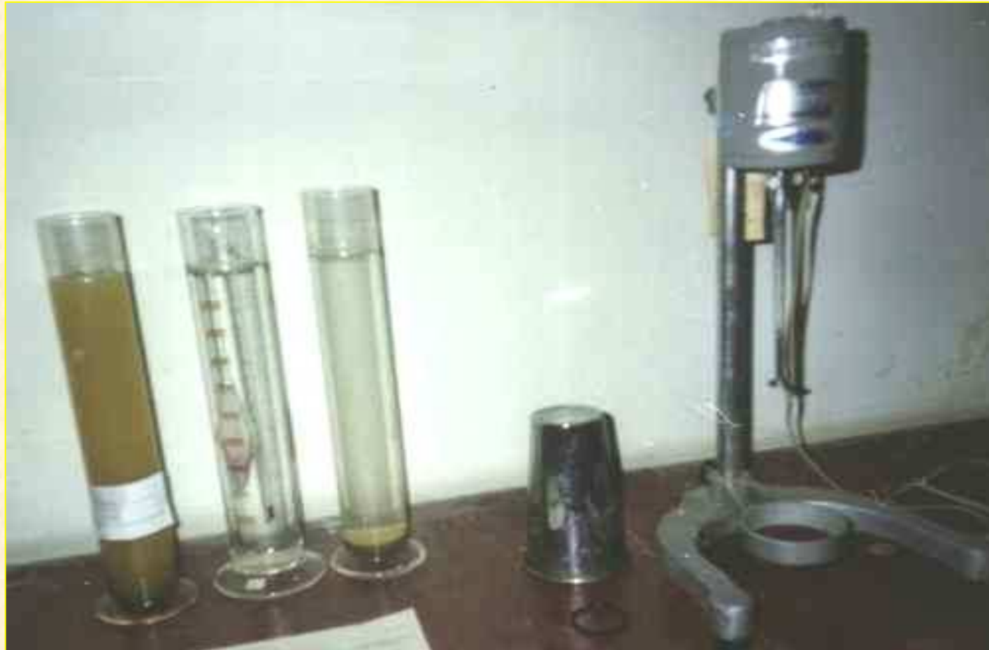
ENSAYO DEL DOBLE HIDRÓMETRO, EQUIPO UTILIZADO EN ESTE ENSAYO.
