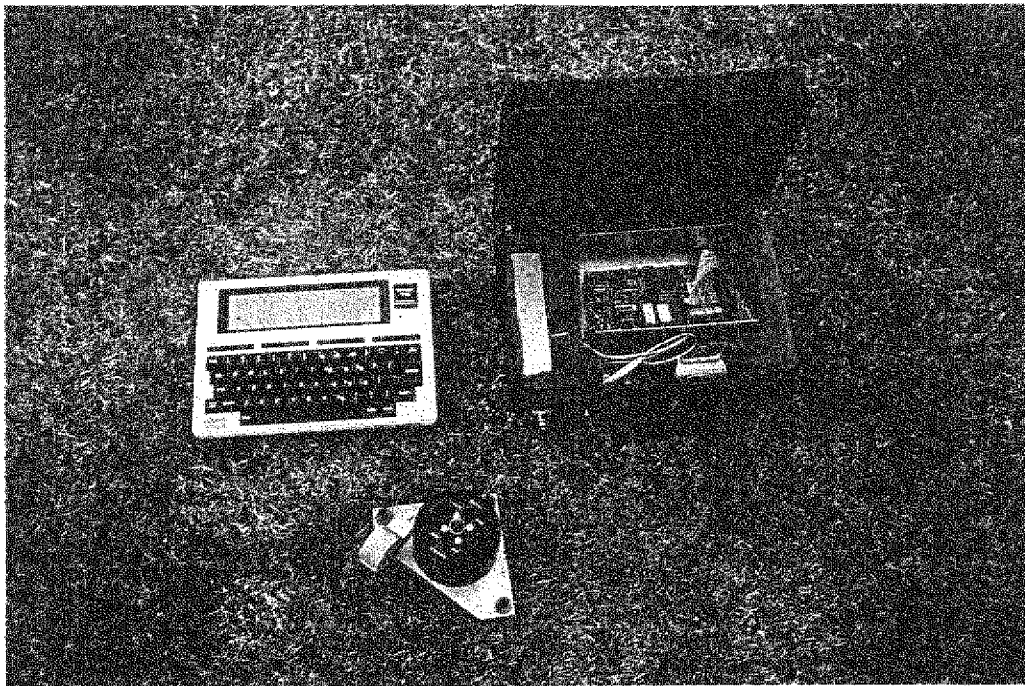
Figura 38. Módulos para la instrumentación de una estación inclinométrica: sensor biaxial (abajo), equipo acondicionador de datos y transmisor (derecha) y computadora (izquierda) para la calibración e intercomunicación con el acondicionador. El equipo fue diseñado por el Cascades Volcano Observatory del USGS.
